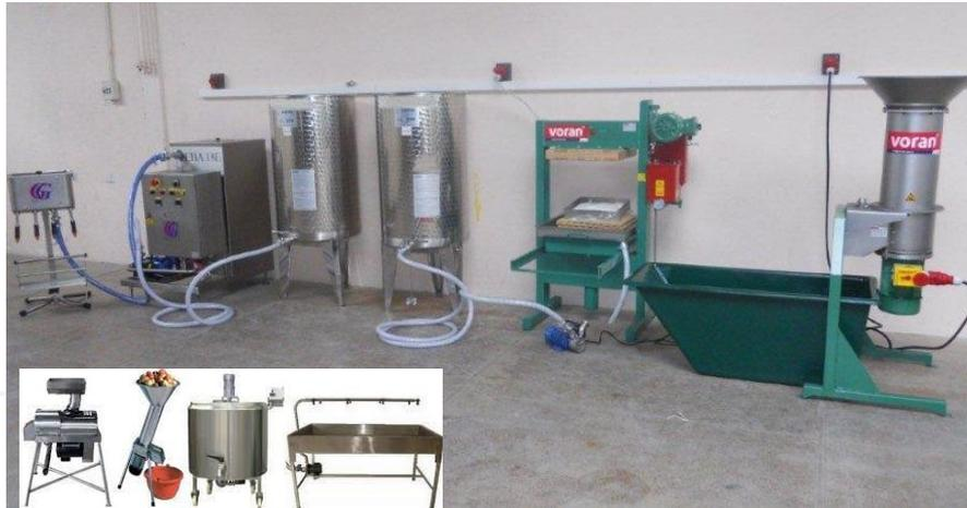
Ligne complète pour la transformation de fruits en jus de fruits comprenant : broyeur-pressoir-cuves-pasteurisation-tireuse
